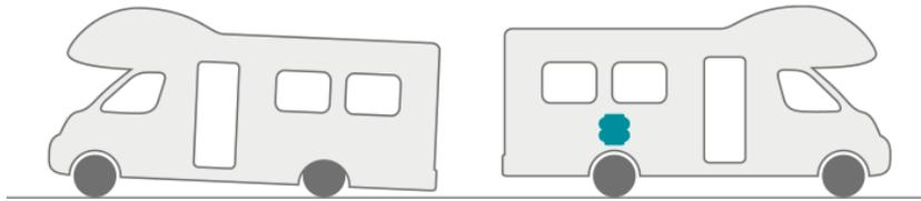
Die Bedienung des Systems ist denkbar einfach: Mit nur einem Knopfdruck lassen sich die Luftbälge der Hinterachse synchron befüllen. Dadurch wird das Fahrzeugheck verwindungsfrei angehoben. Sollte das Reisemobil nach dem Befüllen der Luftbälge bauart- oder beladungsbedingt nach einer Seite hängen, so lässt sich die zu hohe Seite problemlos mit einem Tastendruck absenken. Somit ist eine einhändige Bedienung jederzeit gewährleistet.
