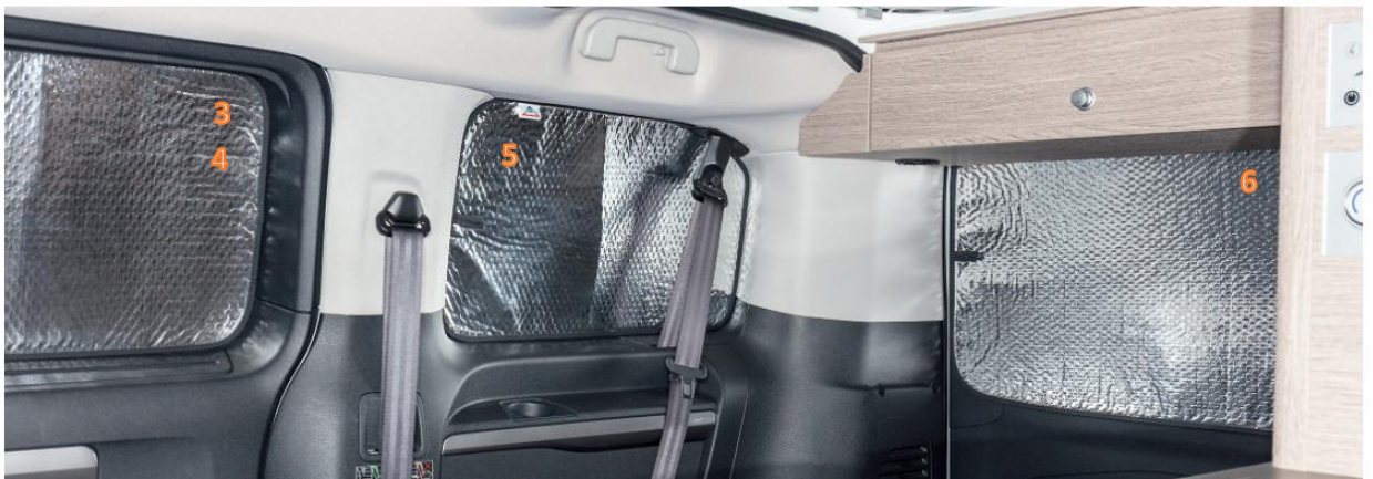
ISOLITE Inside für die Schiebetür-Fenster. Befestigung rundum mit Klettverschluss.
