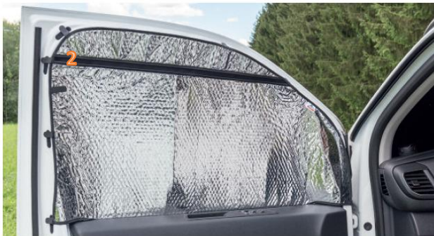
ISOLITE Inside wird mit Klettverschluss am seitlichen Fensterrahmen befestigt. Beim Schließen der Tür wird die ISOLITE-Matte an die Türdichtung angepresst und abgedichtet: Es entsteht eine großzügige doppelwandige Isolation.
