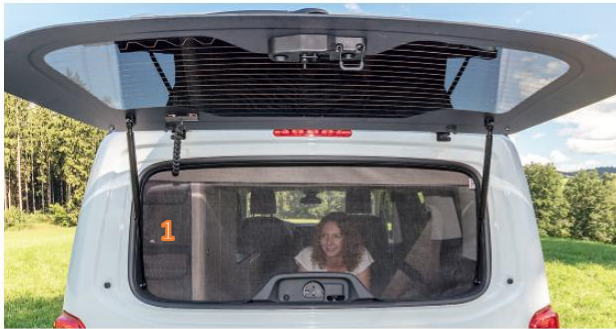
FLYOUT für das Heckklappenfenster. Das Moskitonetz wird rundum dicht mit Klettverschluss befestigt.
