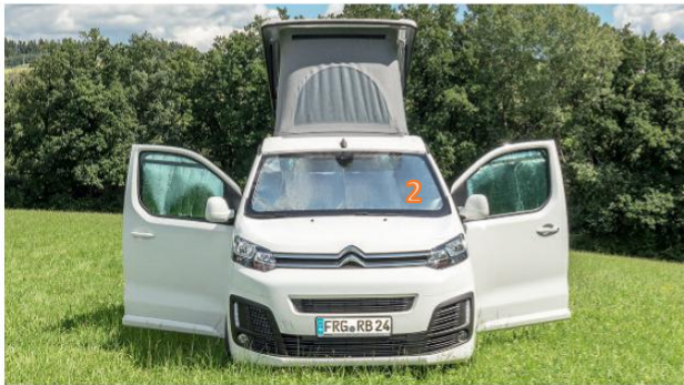
ISOLITE Inside für die Fahrerhausfenster. ISOLITE wird an der Windschutzscheibe oben mit Klettverschluss befestigt.
